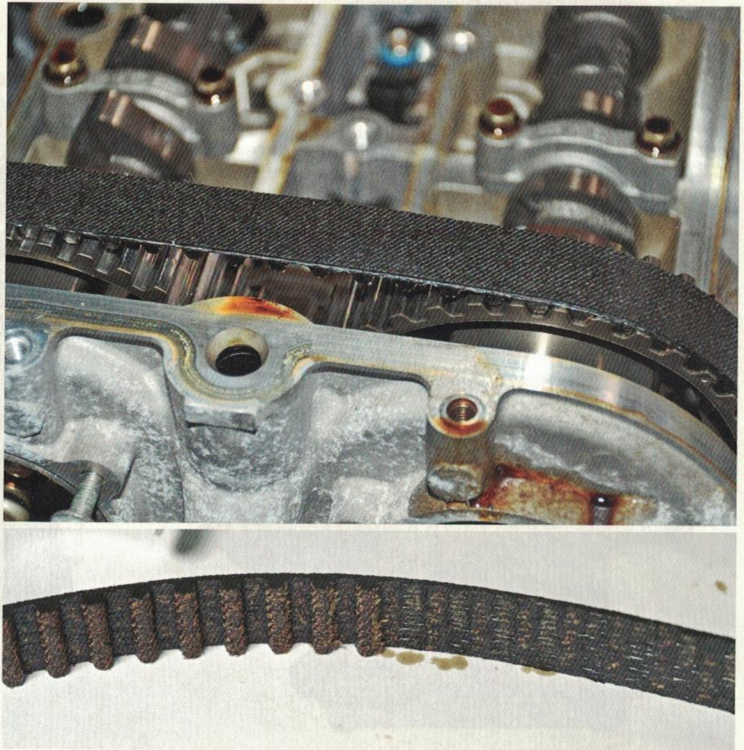
Bekannte Beispiele für Motoren mit Zahnriemen im Öl sind der Ford 1.0-I-EcoBoost und der 1.2-I-PureTech des PSA-Konzerns. Falsches Öl zersetzt den Riemen, der sich in Folge auflöst, Zähne verliert oder reißt.
